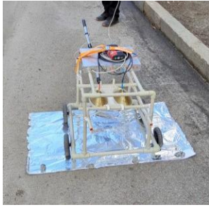
Рис. 5. Калібрування з використанням листа металу
